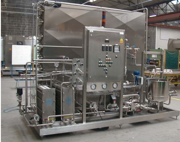
PLATE PASTEURIZER: 750 – 1000- 1250 L/hr
